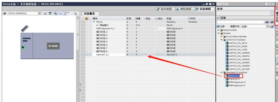
c. 主站模块 PN-08IOL 的 1 端口和 2 端口后接入了 IOL0808-HUB 模块，在右侧“硬件目录”下找到模块，右击“端口关闭\_2”选择“删除”后，双击“LATCOS\_IOL\_0808”或者“IOL\_I/O\_01/01 byte”添加 IO-Link 从站到组态，如下图所示。（注：IOL0808-HUB 配置 8 通道输入 8 通道输出，所以选择 01/01 byte。）
