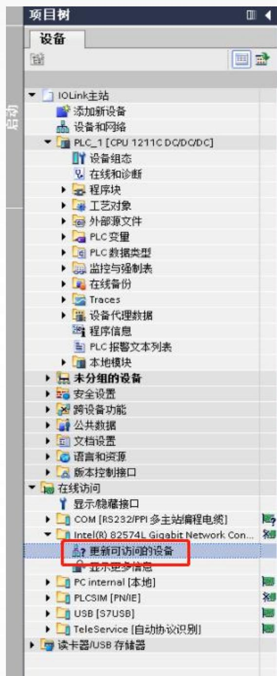
b. 更新完毕，显示连接的从站设备，如下图所示。
